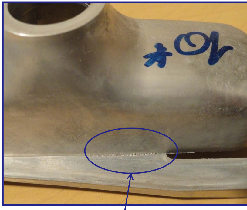
Testimone dell'erosione da cavitazione
